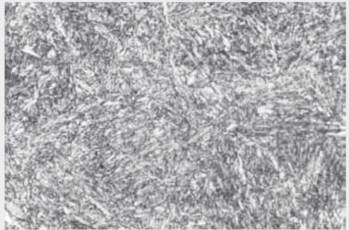
Bild 2: Mikrostruktur eines Stabstahls aus 41Cr4 nach Abschrecken und Anlassen in einer Elotherm TemperLine™ (1000-fach vergrößert)
