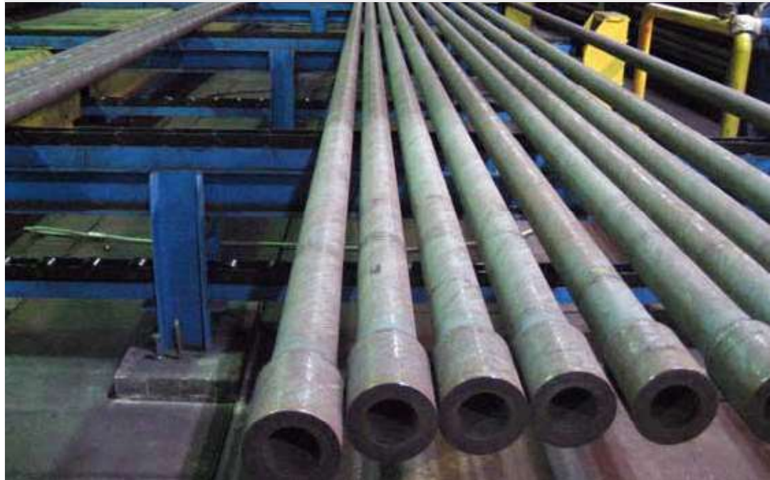
Bild 6: Das Ergebnis des induktiven Quench & Temper-Prozesses von Rohren mit gestauchten Enden – überzeugende Geradheit ohne Richt- oder Kalibrierprozesse
