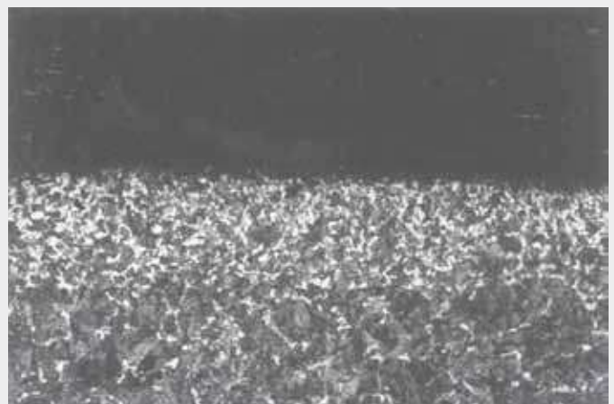
Bild 3: Mikrostruktur eines kaltgezogenen Rohstabs aus 41Cr4 (160-fach vergrößert)
