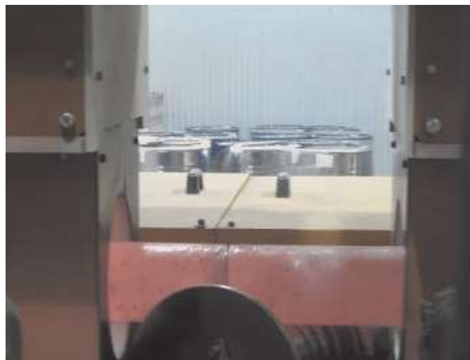
Bild 8: Nahtlose, dickwandige Rohre mit dazwischen liegenden Induktionsspulen während des Vergütungsprozesses in einer typischen Induktionshärte- und Induktionsvergütungsstrecke
