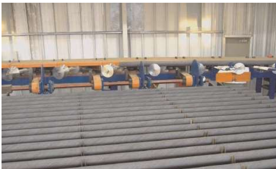
Bild 5: Nahtlose, dickwandige Rohre nach der Induktionshärtung /-vergütung Fig. 5: Seamless thick wall tubes after induction Hardening & Tempering process
