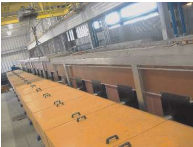
Bild 7: Anlassinduktoren in einer typischen Induktionshärte- und -vergütungsstrecke im Überblick
